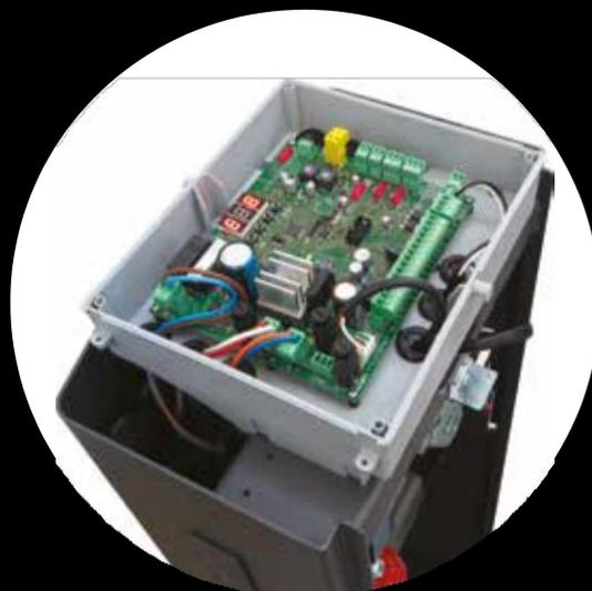
O display prático de três segmentos e as teclas de controle permitem navegar pelo menu e configurar a barreira em poucas etapas simples.
